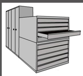
Materiales inertes, no combustibles ni corrosivos: metal cromado, acero inoxidable, aluminio anodizado; o metal con recubrimiento de pintura esmaltada al horno o de pintura epoxídica.
