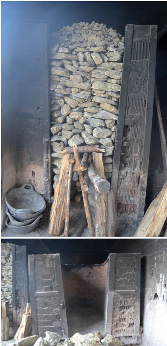
Figura 2. Hornos para la producción tradicional del yeso en la fábrica de Yeso Albarracín Artesano, Teruel (Foto: C. J. Grau y V. La Spina, 2016).
