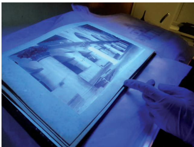
Figura 6. Uso de luz ultravioleta aplicado sobre materiales fotográficos para la identificación de elementos, el diagnóstico de patologías y la evaluación de la eficacia del tratamiento en una intervención. Fotografía: A. Guerrero.
