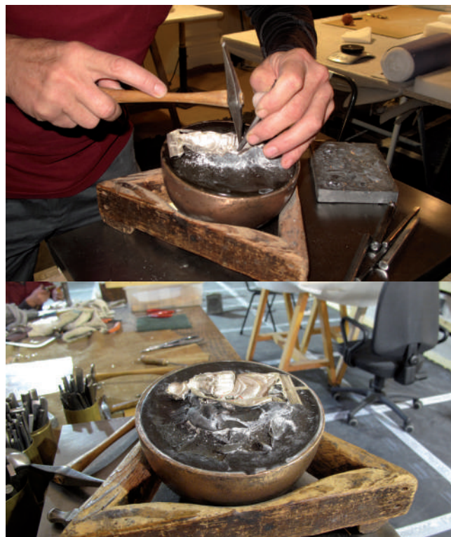
Figuras 8 y 9. Conformado de un refuerzo interno. Talleres de Arte Granda
