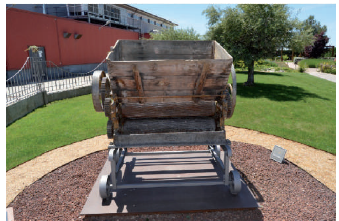
Figura 2. Vista de estrujadora, artefacto industrial para la transformación de la uva, perteneciente al patrimonio industrial mueble del siglo XX, fabricada en Alcoy. Su ubicación al exterior obliga a un mantenimiento periódico. ©Gerardo José Casaseca García
