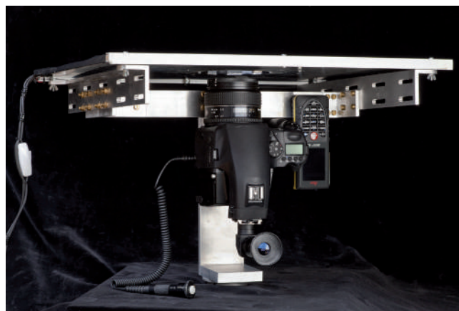
Figura 1. Sistema integrado por iluminación, posicionamiento y cámara diseñado para la cueva de Altamira
