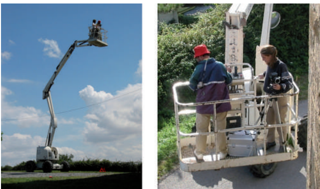
Figura 2. Toma de fotografías con cámara fotogramétrica y empleo de una grúa para situarse en los puntos de vista adecuados para el registro estereoscópico (Torre de Martiartu en Erandio, Bizkaia) en el año 2002. La fotografía de la izquierda muestra el momento de la toma mientras que en la imagen de la derecha se muestra el equipo fotográfico empleado (cámara Rollei 6006 con película de 6x6 cm).
