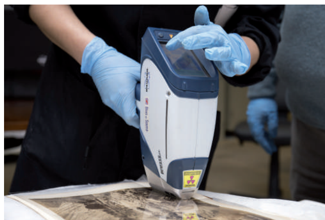
Figura 1. Análisis por Fluorescencia de Rayos X en una fotografía para identificar sus elementos químicos, con el objetivo de aportar datos para complementar su estudio histórico. Fotografía: M. De Sousa e I. Domingues, Fundação Calouste Gulbenkian .
