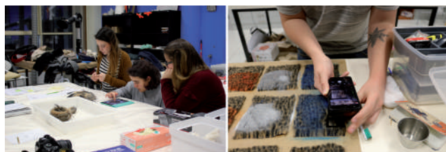
Figura 6. Alumnado realizando un Condition Report empleando un Ipad y un Smartphone para registrar el estado de conservación de una obra. En la derecha, un alumno utilizando un móvil para fotografiar, a través de un cuentahilos, los cambios tras aplicar un tratamiento sobre probetas.
