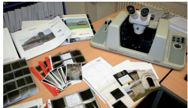
Figura 3. Pares fotogramétricos de varios proyectos junto al restituidor Adam MPS-2. La fotogrametría estereoscópica en película fue la técnica predominante en la documentación geométrica hasta la irrupción y generalización de la fotografía digital de alta resolución (durante los primeros años de la década del 2000).
