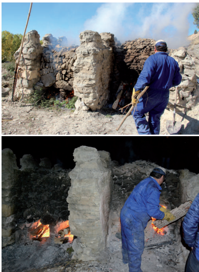
Figura 5. Calcinación de hornos tradicionales de yeso en Navarrete del Río, Calamocha, Teruel (Foto: C. J. Grau y V. La Spina, 2016).
