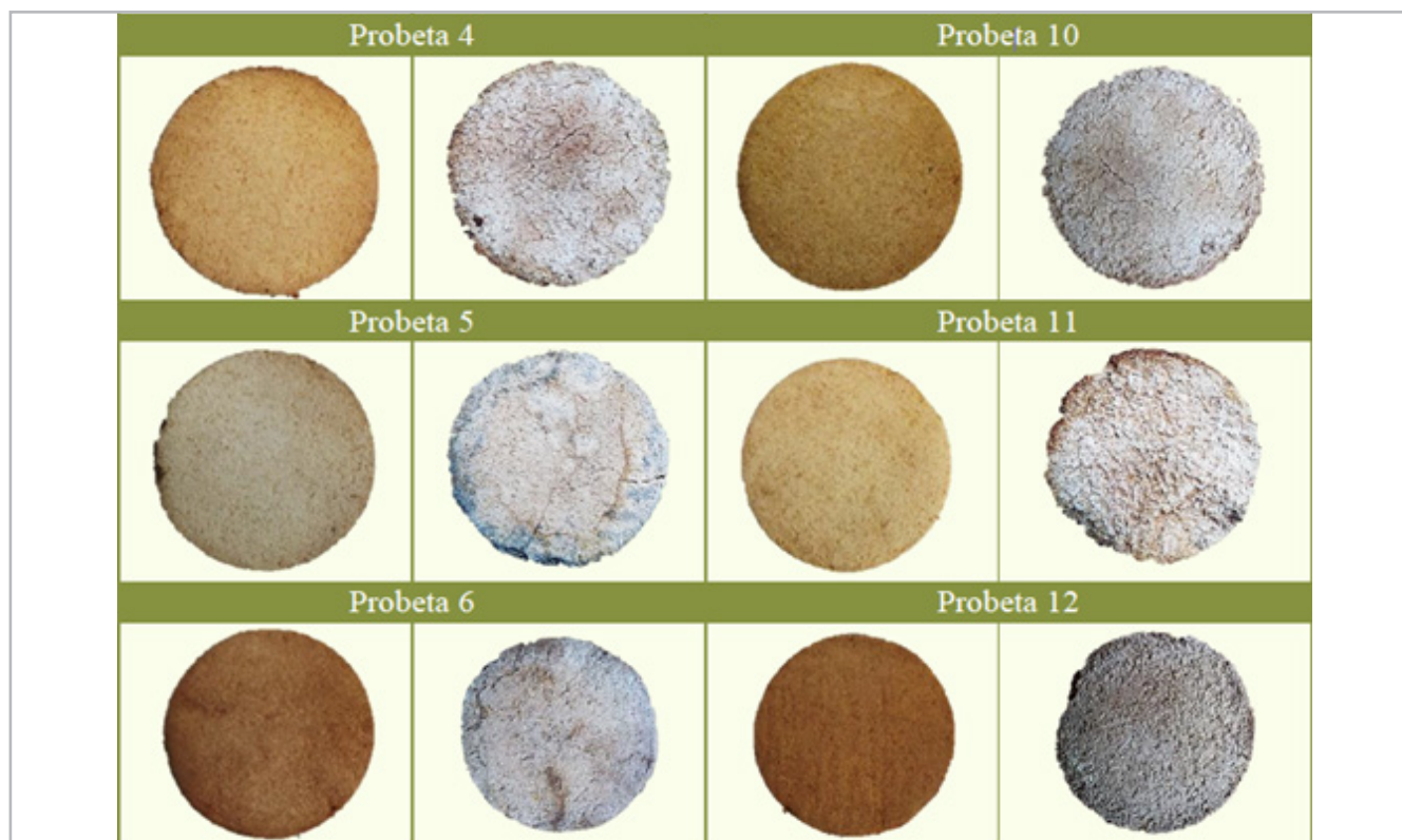
Figura 4.- Comparación de las 12 probetas antes y después del proceso de envejecimiento por intemperismo (Elaboración propia 2017)
