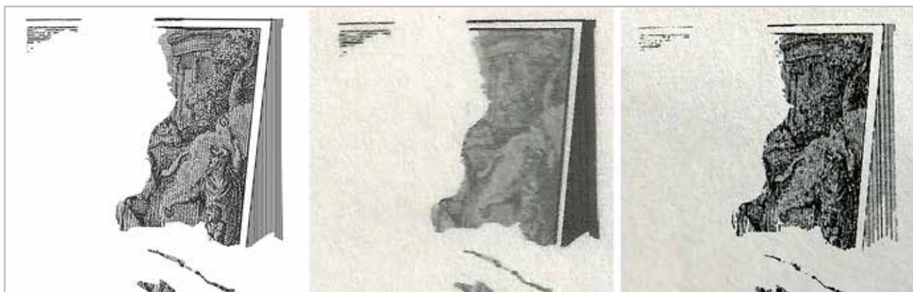
Figura 4.- Comparativa de definición de laguna a injertar: imagen digital, impresión inkjet sobre metilcelulosa e impresión láser sin imprimación.
