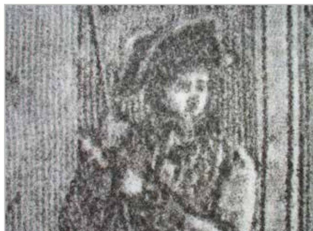
Figura 3.- Detalle de la probeta II, impresa con inkjet y dos capas de gelatina, capturada mediante aumento de 0.8X en microscopio óptico.
