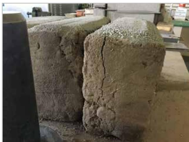
**Figura 4.-** Bloque fracturado por la compresión. Fuente: Elaboración propia
