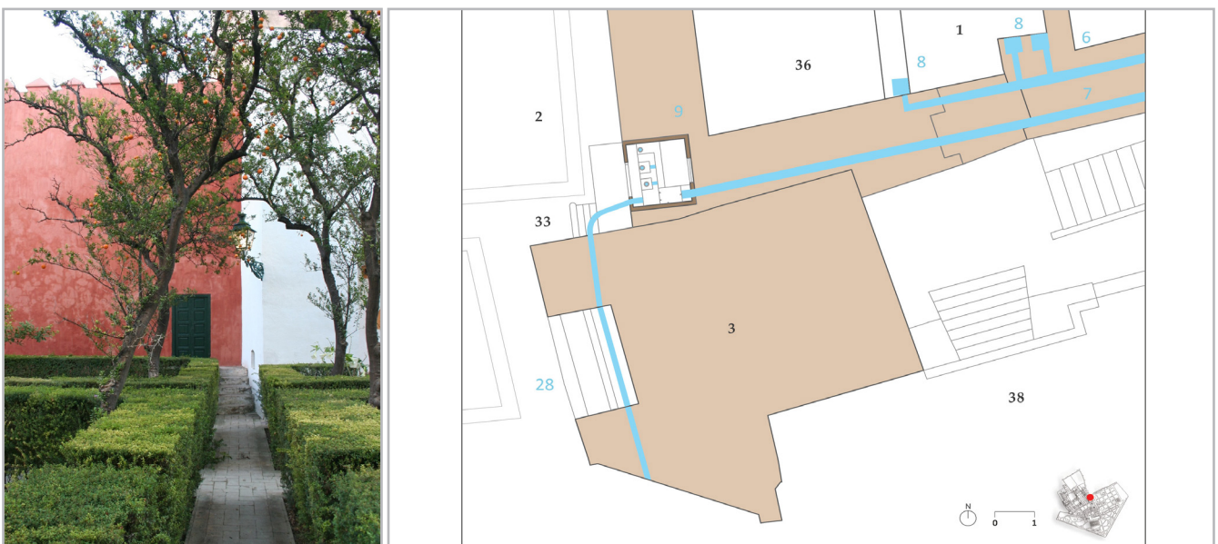
Figura 3.- Ubicación del arca principal de distribución del Alcázar. (a) Imagen de la puerta de acceso al cuarto en el Jardín del Chorrón. (b) Plano de la localización de la arqueta. (1) Postigo del agua, (2) Jardín del Chorrón, (3) Torre del Agua, (6) Cañería vieja, (7) Cañería nueva, (8) Arcas secundarias, (9) Arqueta de distribución, (28) Acequia Torre del Agua, (33) Escalera, (36) Viviendas y (38) Jardín de la Vega Inclán
