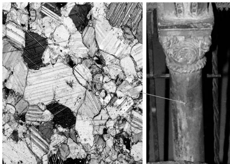
Fig. 2: Fuste columna central, mármol calcítico. Imagen de detalle donde se observa la heterometría de los cristales de calcita, su morfología anhedral y el predominio de uniones intergranulares curvas
