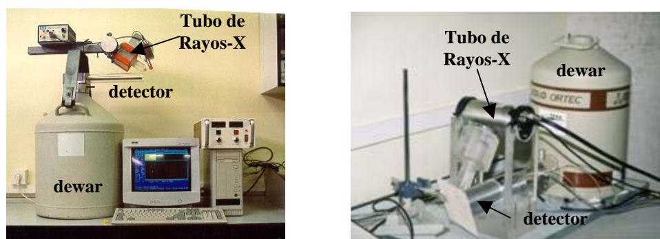
Figura 1. a) Configuración estática con detector Si(Li) OXFORD (izquierda); b) Configuración estática con detector Si(Li) ORTEC (derecha).
